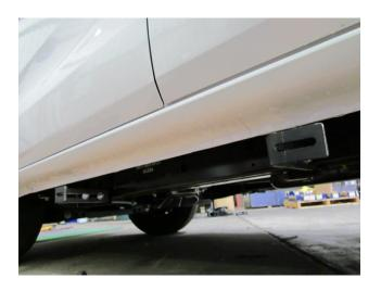
SLIDE BRUSH RAILS ONTO SPIGOT/SPIGOTS ON BULLBAR
